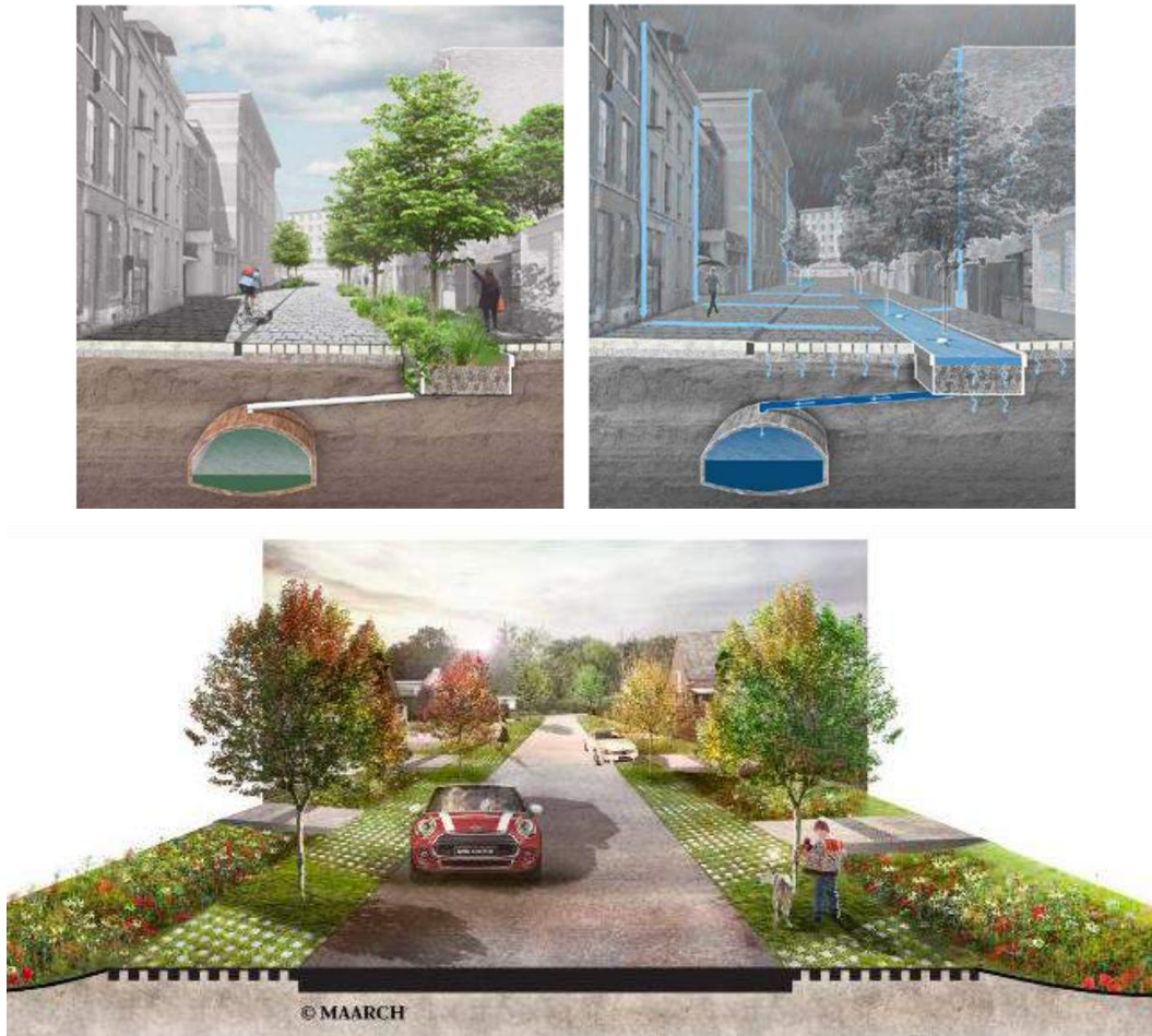
Figuur 35. Herinrichting van straten, met integratie van groenvoorzieningen en infiltratie, naar aanleiding van rioleringswerken: 1) binnen het verstedelijkt gebied (Leuven, bron: De Urbanisten) en 2) in straten met meer ruimte voor voorzieningen ( Heusden-Zolder , bron: blauwgroenvlaanderen)
